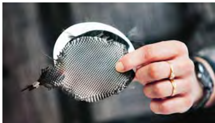
Leväakku koostuu kolmesta komponentista. Paperinohuista hiilielektrodeista, ladattavasta leväpaperista ja tavallisesta keittosuolaliuokseen kastetusta suodatinpaperista.
